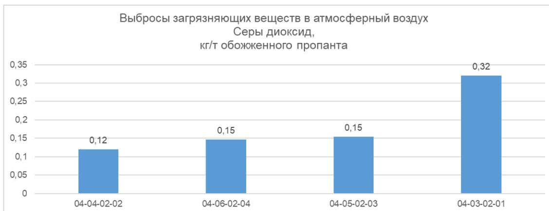
Рисунок 3.24– Выбросы загрязняющих веществ в атмосферный воздух при обжиге керамических пропантов – Серы диоксид
