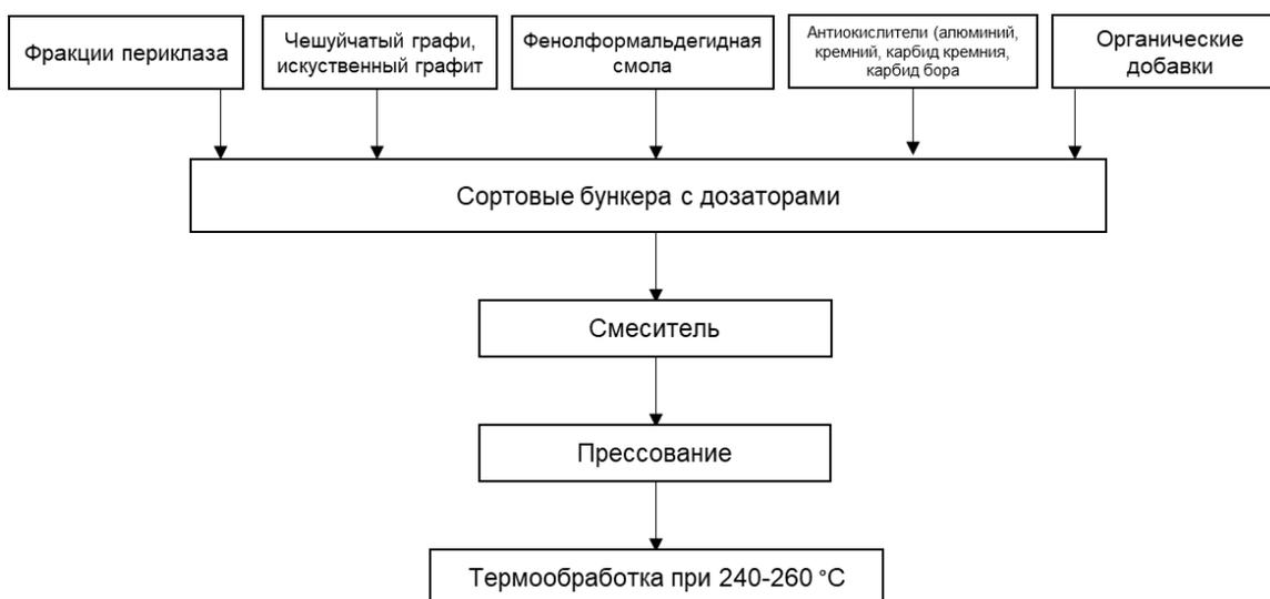
Рисунок 2.11 – Технологическая схема производства углеродсодержащих огнеупорных изделий.
