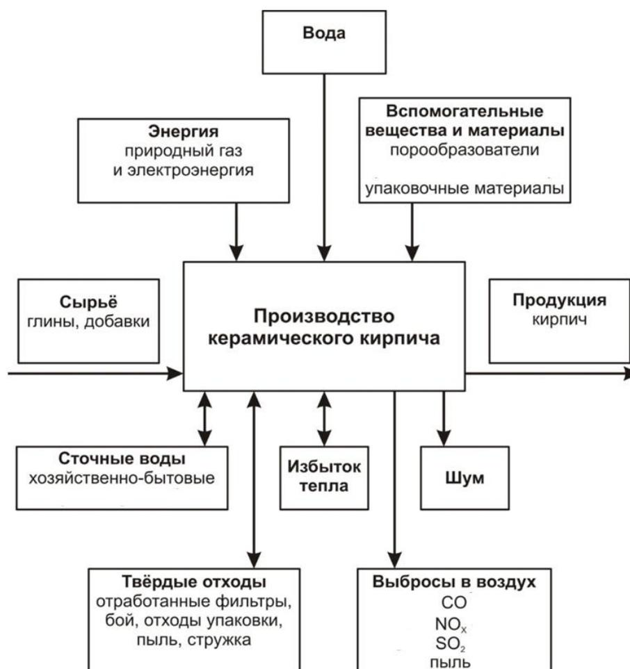
Рисунок 3.5 — Входные и выходные потоки в производстве керамического кирпича в России (количественная оценка)
